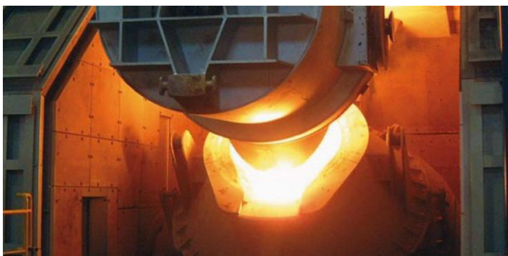
Obr. 2.10 AOD konvertor 180 tun
