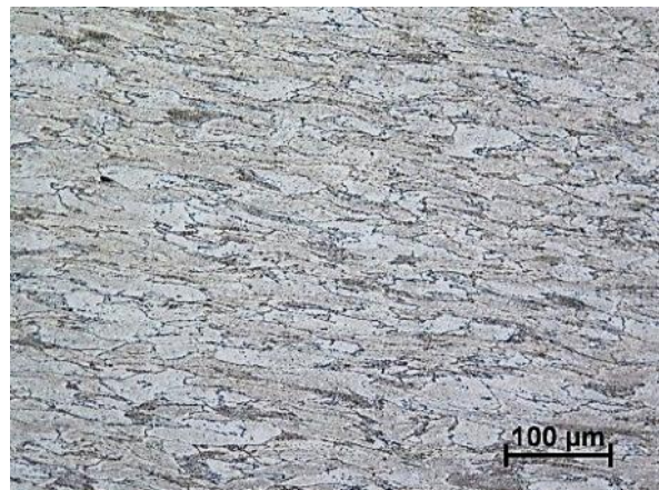
Obr. 5-89 Vzorek 580 °C - 90 MPa - 468 h, LM, v blízkosti lomu
