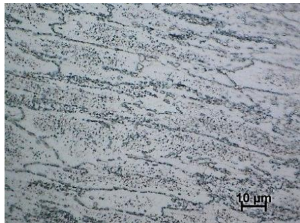
Obr. 5-93 Vzorek 580 °C - 90 MPa - 468 h, LM, v blízkosti lomu
