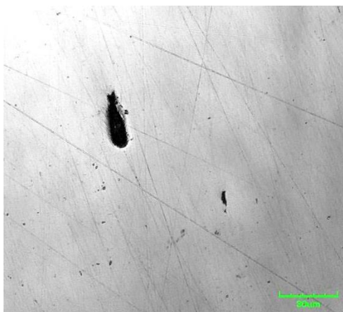
Obr. 5-195 Kavita, neleptaný povrch
