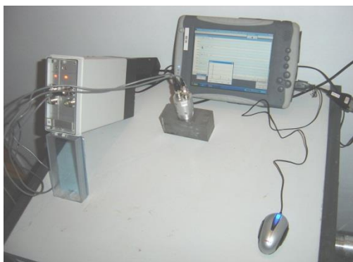
Obr. 4-16 Průmyslový počítač s ultrazvukovou sondou EMAT [36]
