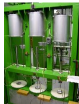
Obr. 5-38 Creepové standy upravené pro SPCT
