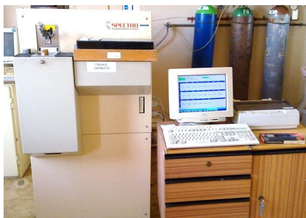
Obr. 5-15 Optický emisní spektrometr
