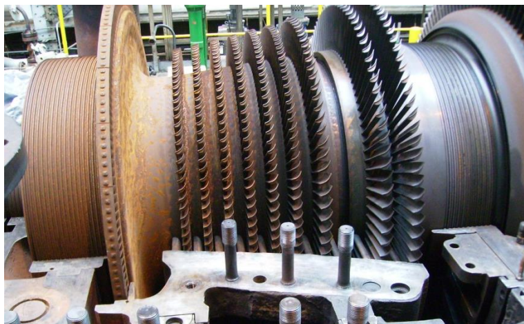
Obr. 3-2 Rotor turbíny, korozní napadení
