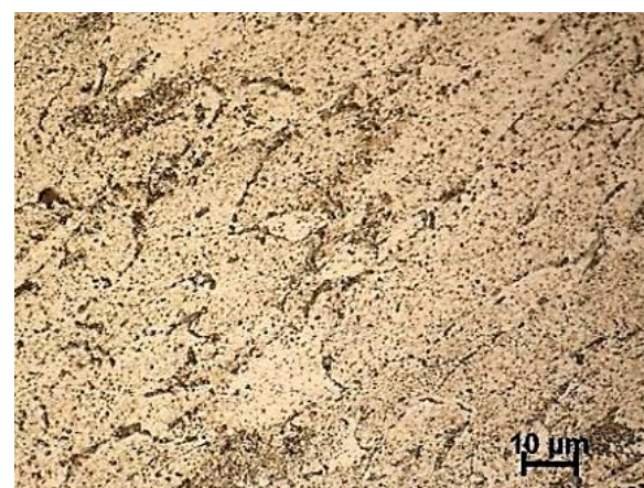
Obr. 5-174 Vzorek 580°C - 140 MPa - 89 h, LM, v blízkosti lomu
