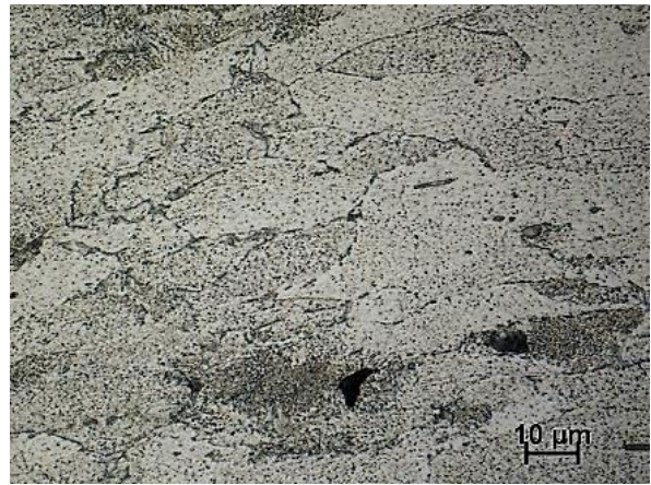
Obr. 5-153 Vzorek 580°C - 120 MPa - 312 h, LM, v blízkosti lomu
