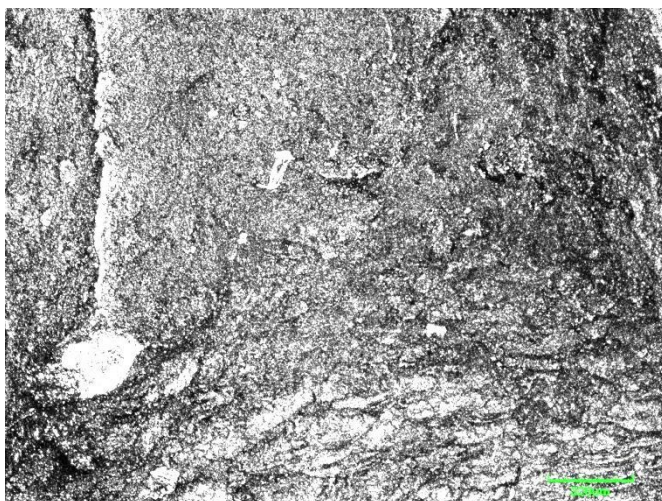
Obr. 5-41 Lomová plocha vzorku po zkoušce tečení
