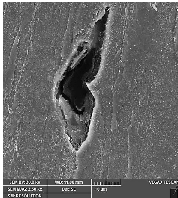
Obr. 5-167 Vzorek 580°C - 120 MPa - 312 h, u lomu,
