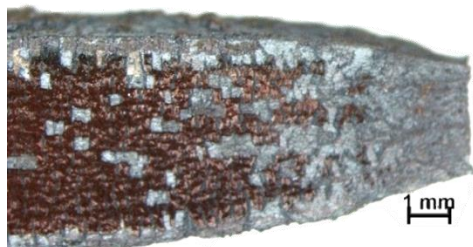
Obr. 5-46 Vzorek po creep testu, okuje
