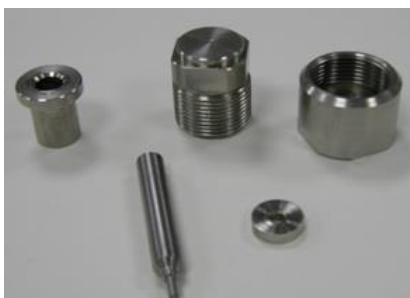
Obr. 5-37 Části přípravku pro SPCT
