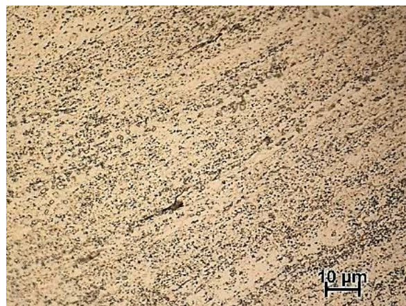
Obr. 5-74 Vzorek 580°C - 80 MPa - 2227 h, LM, u lomu
