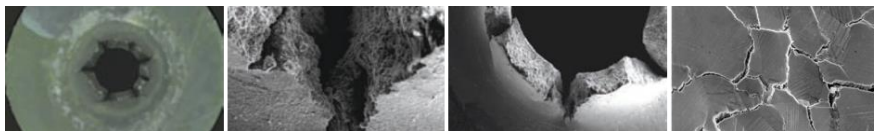
Obr. 4-24 Detail trhliny ve vzorku po SPT
