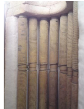
Obr. 5-29 Detail vnitřku odporové pece
