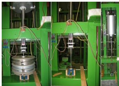
Obr. 4-28 Upravený přístroj pro small punch creep test [59]
