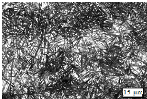
Obr. 51 Režim 900°C/100s–300°C/600s a) grafické zobrazení, b) laserová konfokální mikroskopie
