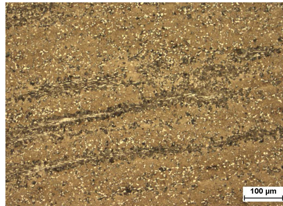
Obr. 127 Polotovar F - materiál 42SiCr, oblast 3, martenzická matrice s vyřádkovaným perlitem a rozptýleným feritem
