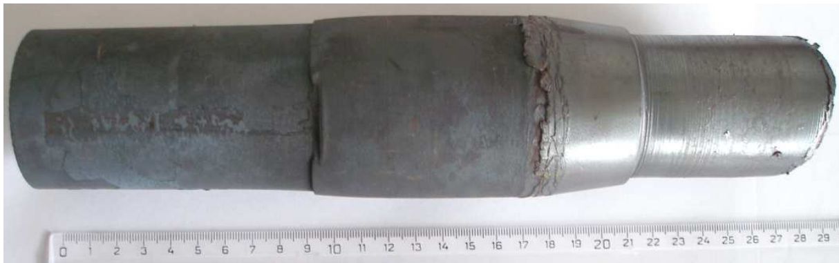
Obr. 103 Detail dutého polotovaru po protlačování při teplotě 900 ÷ 800°C, dutá část vpravo, původní polotovar ve střední části, nosič vzorku vlevo
