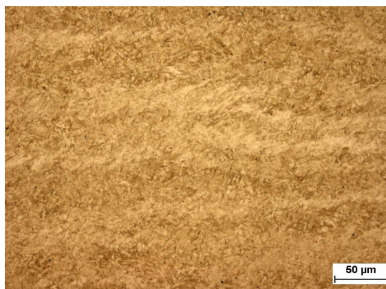
Obr. 116 Polotovar C - materiál 42MnCr, oblast 3 - martenzitická struktura, světelný mikroskop
