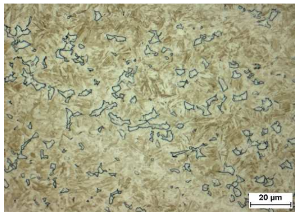
Obr. 115 Polotovar C - materiál 42MnCr, oblast 2 - martenzitická struktura s rozptýleným feritem, světelný mikroskop
