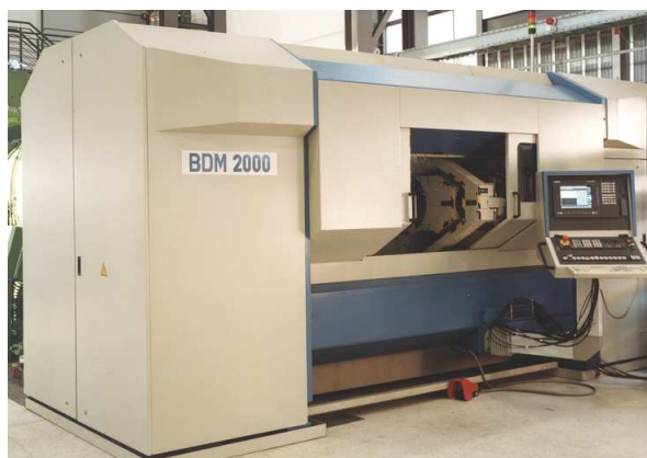
Obr. 25 Zařízení pro rotační zpětné protlačování BDM 2000, Fraunhofer institut v Chemnitz [86]
