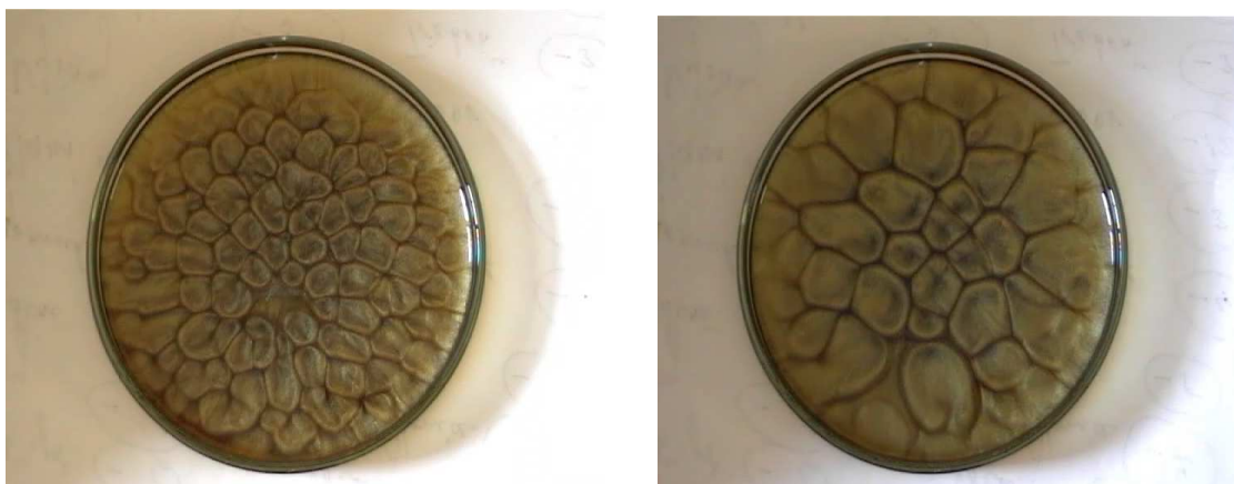
Obr. 1: Vznik Bénardových buněk, vlevo větší vertikální gradient teploty T , vpravo menší [foto autor].
