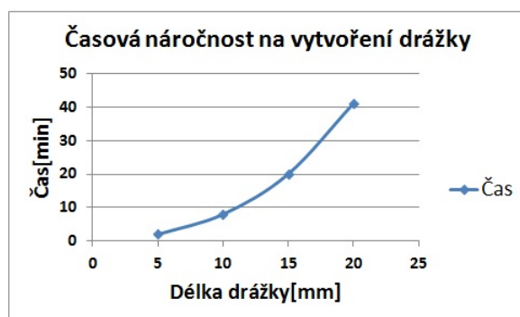
Obrázek 3.5: Vliv délky drážky na dobu jejího vytvoření
