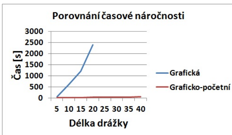
Obrázek 3.9: Porovnání časové náročnosti na vytvoření drážky pomocí různých metod
