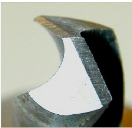
Obrázek 2.7: Používané plochy pro vytváření hřbetu monolitního šroubovitého vrtáku
