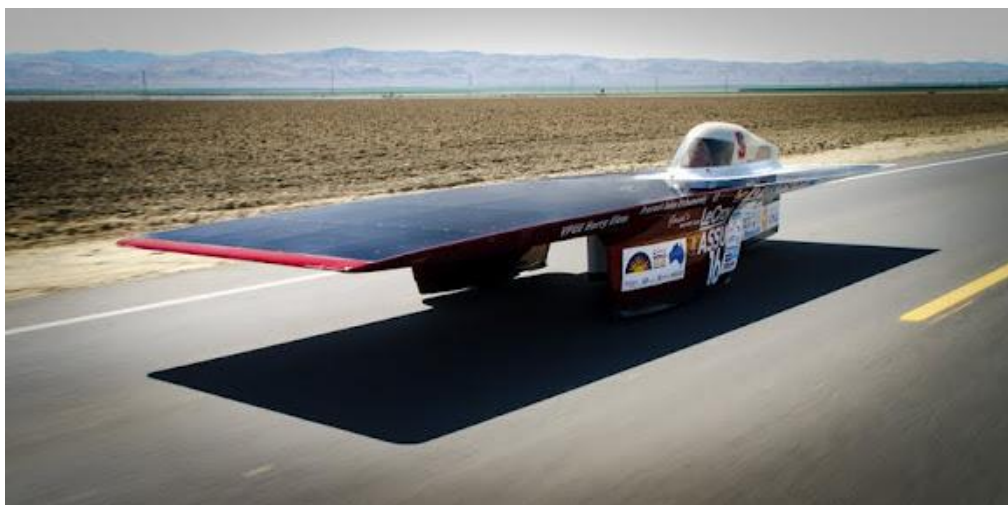
Obr. 3.4 Solární vozítko Xenith [19]
