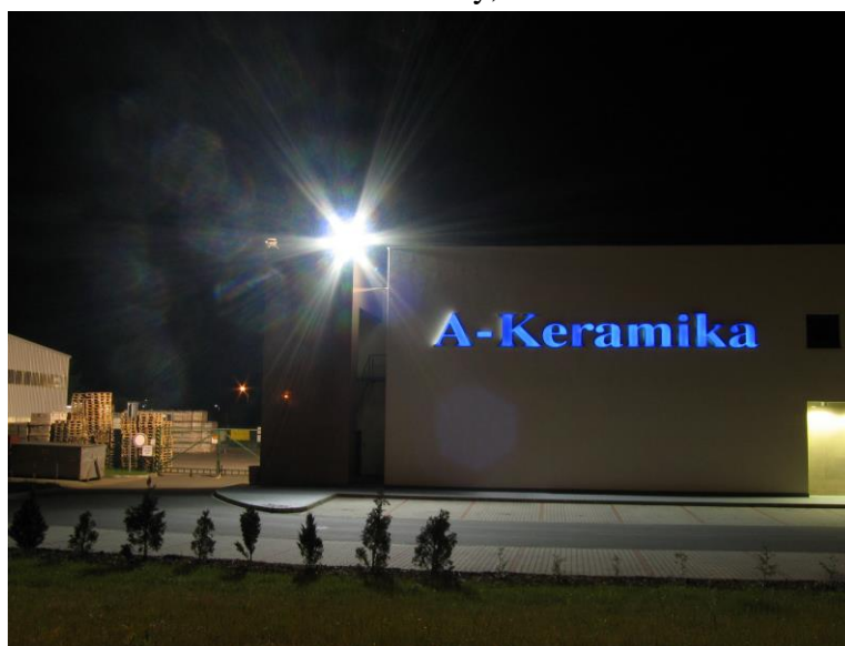
Obr 20: Špatné architektonické světlo, možné k využití trestné činnosti. Světlo svítí na parkoviště ale vchod je tmavý a ještě světlo může oslňovat lidi. (zdroj: http://svetelnezncisteneni.cz/co-je-svetelne-zncisteneni/bezpecnost/ )
