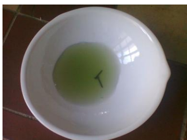
Obr. 55 Reakce kyseliny chlorovodíkové se železem
