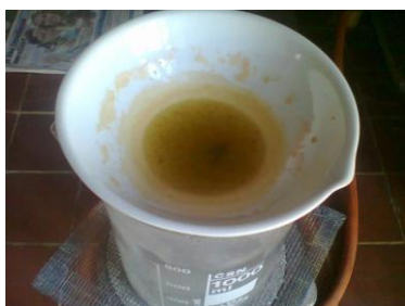
Obr. 56 Roztok chloridu železnatého
