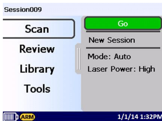
Obr. 19 Hlavní menu Ramanova spektrometru Ahura FirstDefender
