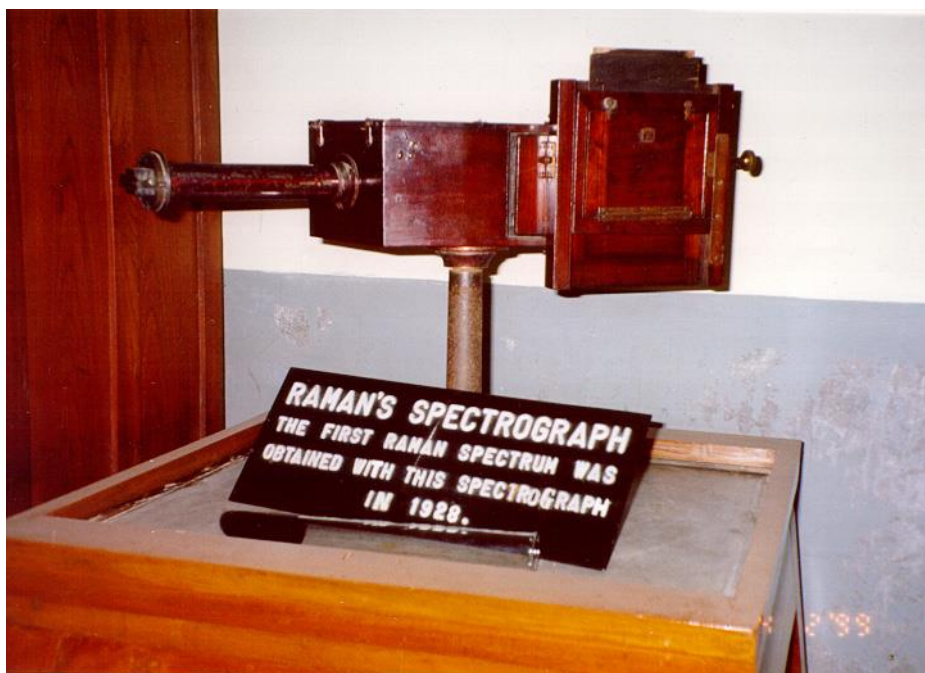
Obr. 1 První Ramanův spektrometr 5
