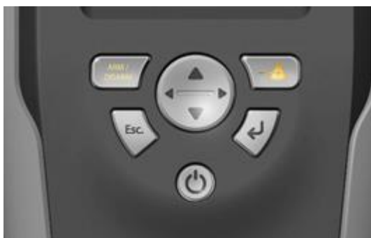
Obr. 18 Ovládací prvky Ramanova spektrometru Ahura FirstDefender
