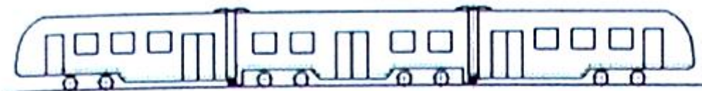
Obrázek 1.3: tříčlánková tramvaj se čtyřmi otočnými podvozky [3]
