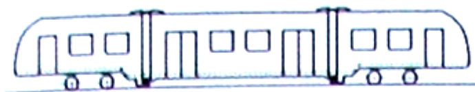
Obrázek 1.1: tříčlánková tramvaj s dvěma krajními články s neotočnými podvozky obvyklé koncepce a jedním neseným článkem [3]
