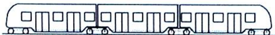
Obrázek 1.5: tříčlánková tramvaj se dvěma otočnými podvozky pod čelem a dvěma otočnými podvozky pod kloubovým spojením článků [3]
