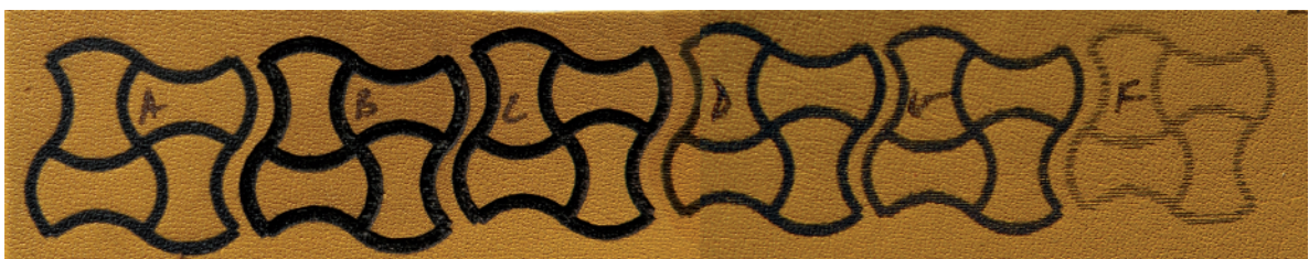
Obr. č. 13 Vektorový motiv a vzorky odlišných typů kůží s laserovým zápisem -rozdílná hloubka a rastr
