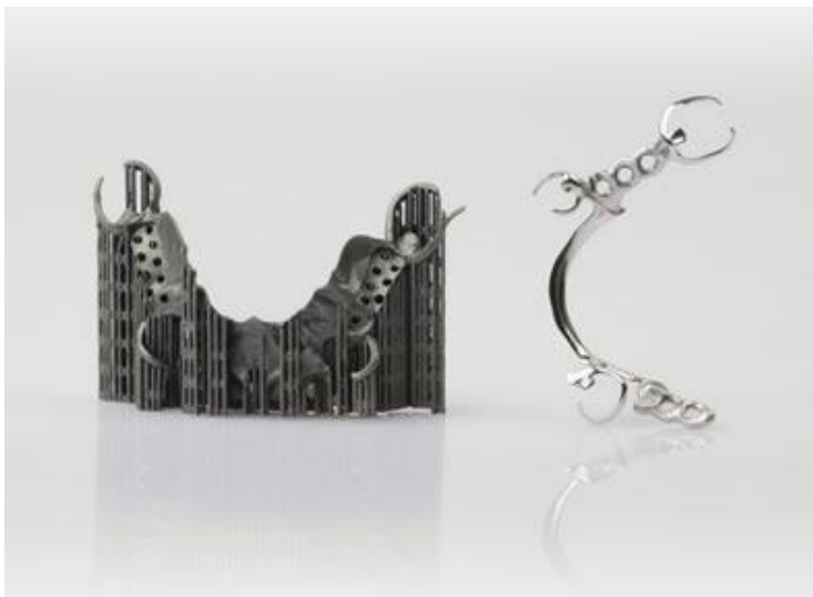
Obrázek 2 - Ukázka zubního můstku před postprocessingem s podpěrnými prvky (vlevo) a po leštění (vpravo) [29]
