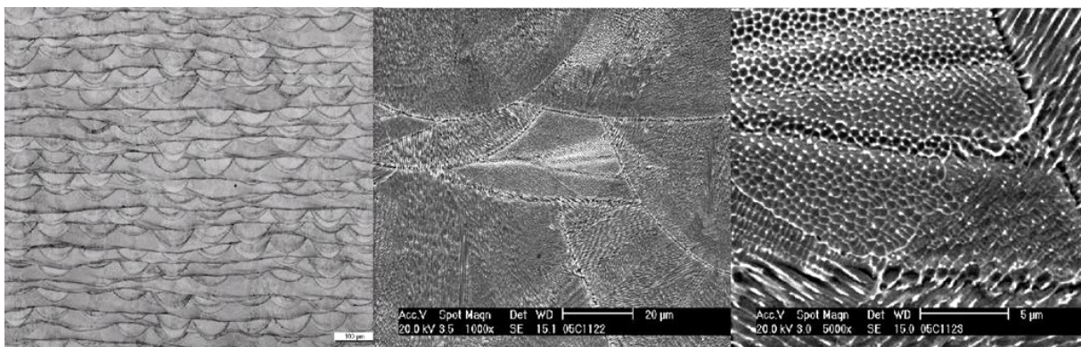
Obrázek 4 - EOS CobaltChrome- MP1, Vlevo: 10x zvětšený. Střed: 1000x SEM Vpravo: 5000x SEM [7]
