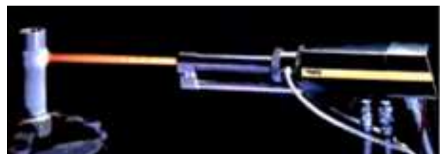
Obr. 2.2: a) schéma vzniku HVOF hořáku a proudu spalin [102], b) viditelné „šokové diamanty“ během HVOF nástřiku [103]
