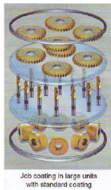
Obr.6 Spôsob uloženia nástrojov v komore [7].
