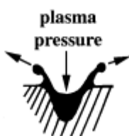
Obr.2 Tvorba makročastíc v katódovej škvrne z tekutého materiálu katódy [6].
