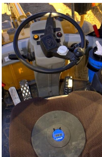
Obr. 4-26 Sedadlový senzor pro snímání vibrací celého těla (69)
