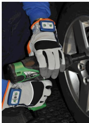
Obr. 4-25 Rukavice se senzorem snímání vibrací (69)
