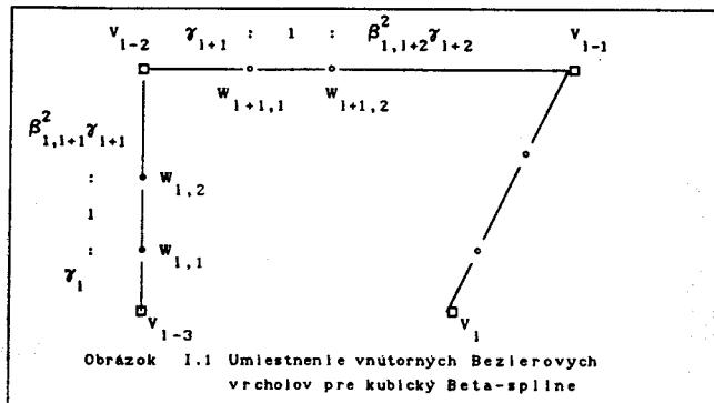
Obrázok I.1 Umiestnenie vnútorných Bezierových vrcholov pre kubický Beta-spline
