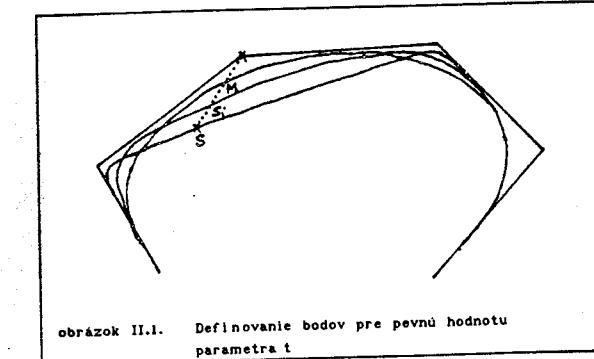
Obrázok II.1. Definovanie bodov pre pevnú hodnotu parametra t
