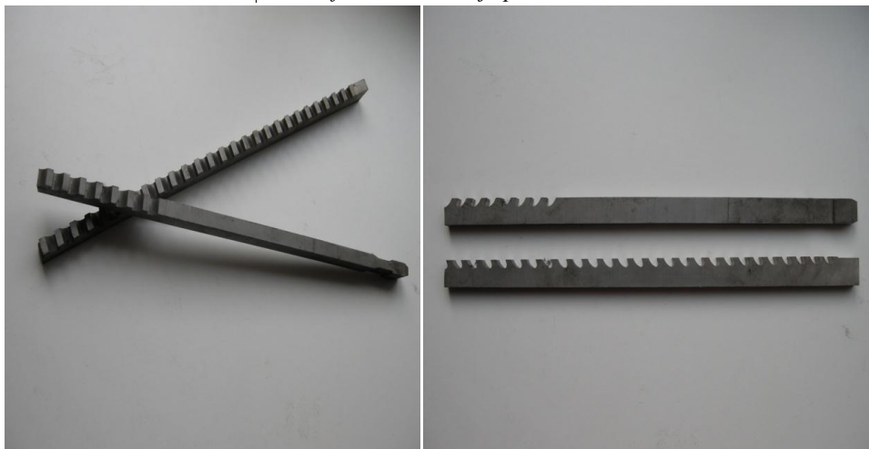
Obr.č. 18: prasklé nástroje po zakalení ve vakuové peci Schmetz
