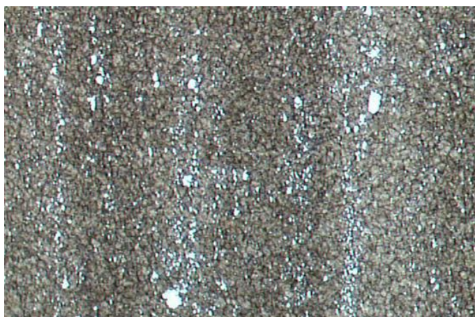
Obr.č.14: mikrostruktura po TZ ve vak. pecích
