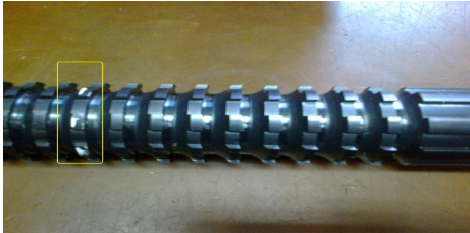
Obr. č. 19: vyštípané zuby po 1. průtahu – TZ ve vakuu
