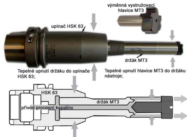
Obr. 2. Hlavice MT3 v držáku. Fig. 2 MT3 head in tool holder
