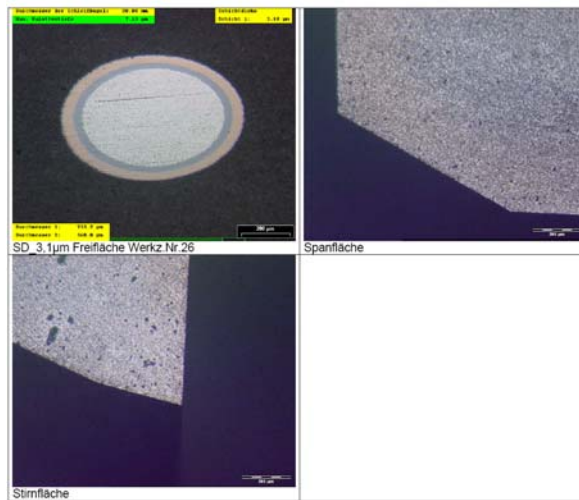
Obr.9. Fotografie kaloty na MT3 s povlakem HSN 2 . Fotografie břitů MT3-II před povlakem, nepískováno
