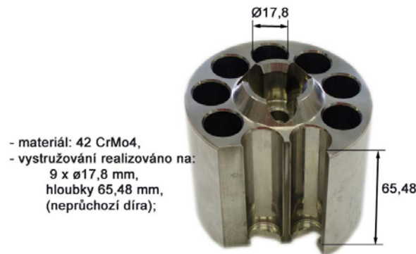
Obr. 3. Těleso hydromotorů Fig. 3 Hydraulic motor body
