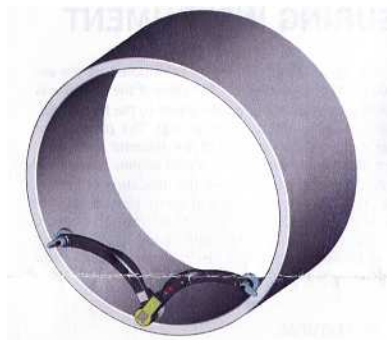
Obr. 8 Ukázka měření vnitřního průměru[5]
