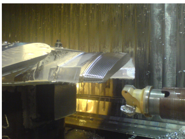
Postupné hrubování s profilem rádiusu
