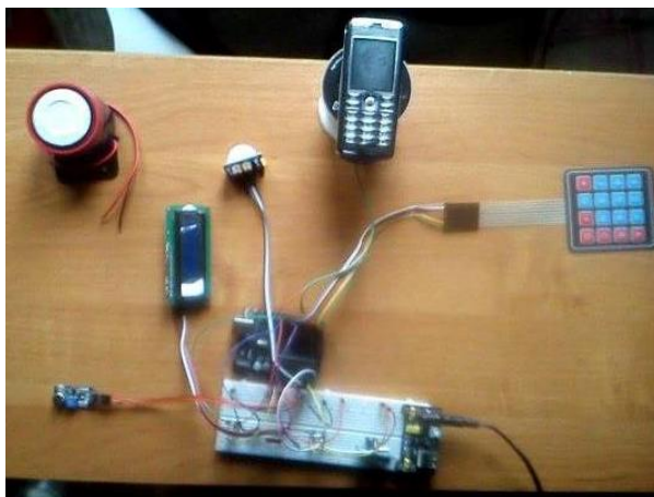
Rys. 5. Układ systemu alarmowego testowanego na płycie prototypowej (źródło: opracowanie własne).
