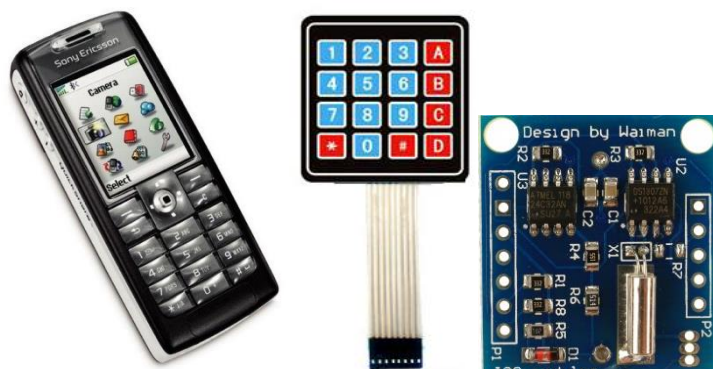
Rys. 2. a) Sony Ericsson T630, b) 16 znakowa klawiatura membranowa, c) moduł czasu rzeczywistego (źródło: opracowanie własne).
