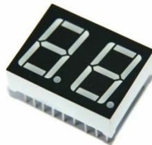
Rys. 4. Wyświetlacz 2 elementowy (źródło: opracowanie własne).
