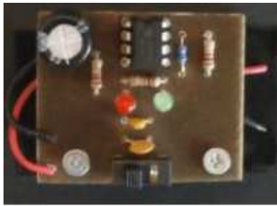
Obr. 8 - osazení součástek na DPS
