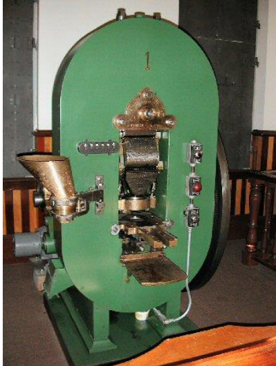
Obrázek 39 Lis pro ražení mincí Coin Press No. 1 (vlevo) (20) a lis na výrobu rozměrných dílů CTUA (vpravo) (21)
