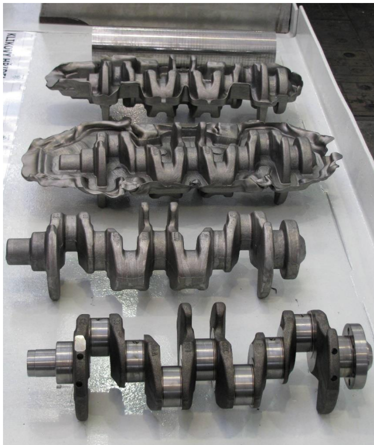
Obrázek 26 Příklad produktu objemového tváření - zápusťkové kování (17)
