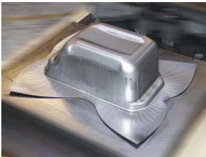
Obrázek 28 Příklad produktu plošného tváření (18)
