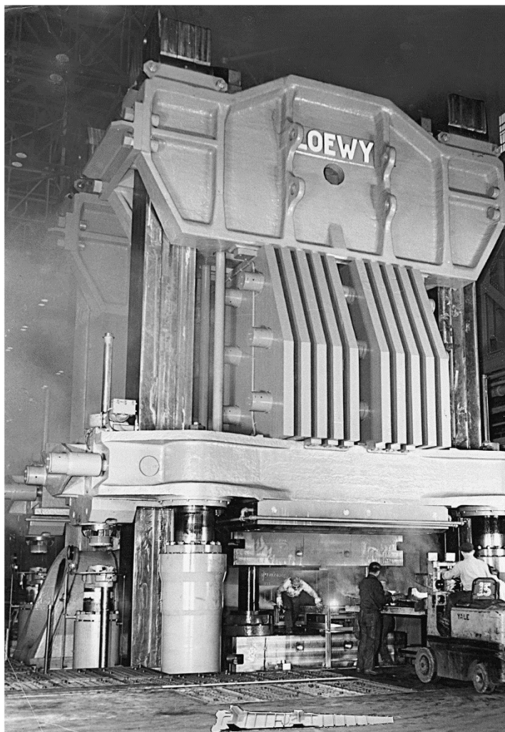
Obrázek 21 Hydraulický lis pro zápustkové kování LOEWY 500 MN (15)
