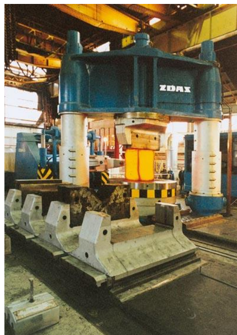
Obrázek 90 Schéma vertikálního provedení hydraulického lisu se spodním pohonem (vlevo) a dvousloupový hydraulický kovací lis se spodním pohonem ŽĎAS a.s. (vpravo) (31)
