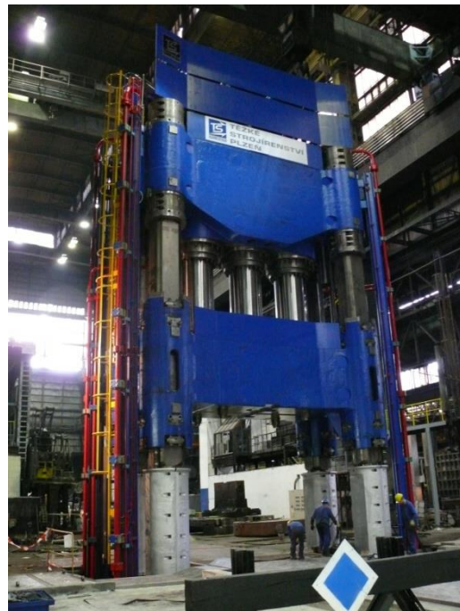
Obrázek 89 Schéma vertikálního provedení hydraulického lisu s horním pohonem (vlevo) a čtyřsloupový hydraulický kovací lis s horním pohonem TS Plzeň a.s. (vpravo) (30)
