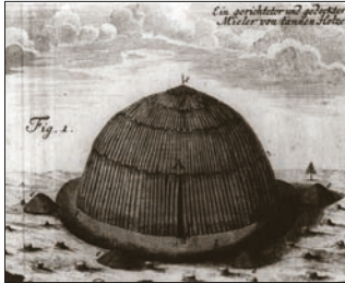
Stojatý milíř před pokrytím těsnicí vrstvou a tzv. mourem, vyobrazený v technologické příručce z 2. poloviny 18. století. (Archiv Národního zemědělského muzea, i. č. B2474).
