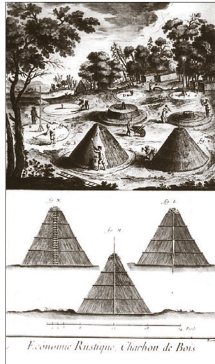
Pohled na uhlířský plac, kde se nachází několik milířů v různých fázích stavby a výpalu. Dole řezy různými typy stojatých milířů. Vyobrazení v technologické příručce z 18. století. (Archiv Národního zemědělského muzea, i. č. B4842).
