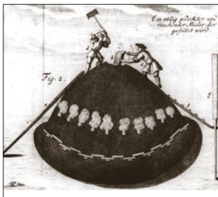
Stojatý milíř na výrobu dřevěného uhlí, do kterého je během výpalu doplňováno dřevo dle vyobrazení v technologické příručce z 2. poloviny 18. století. (Archiv Národního zemědělského muzea, i. č. B2477).
