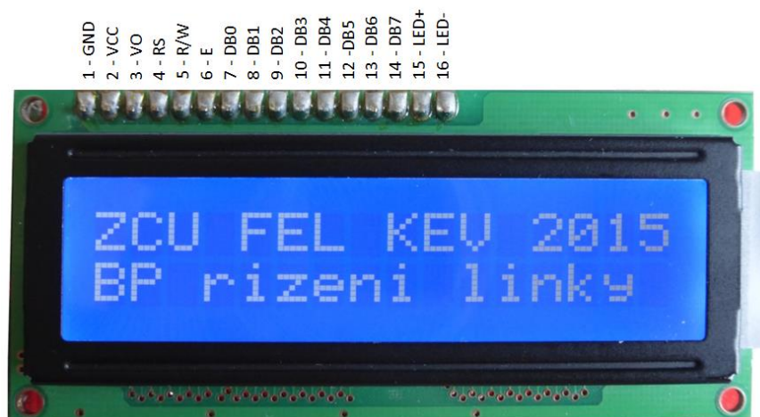
Obr. 4 LCD displej 2x16 HD44870
