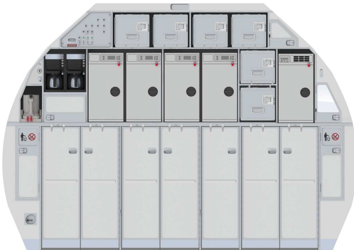
Obr. 14: Custom galley - konečný vzhled
