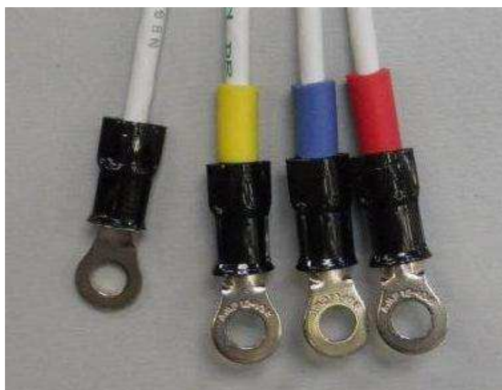
Obr. 24: Barevné značení fázových vodičů
