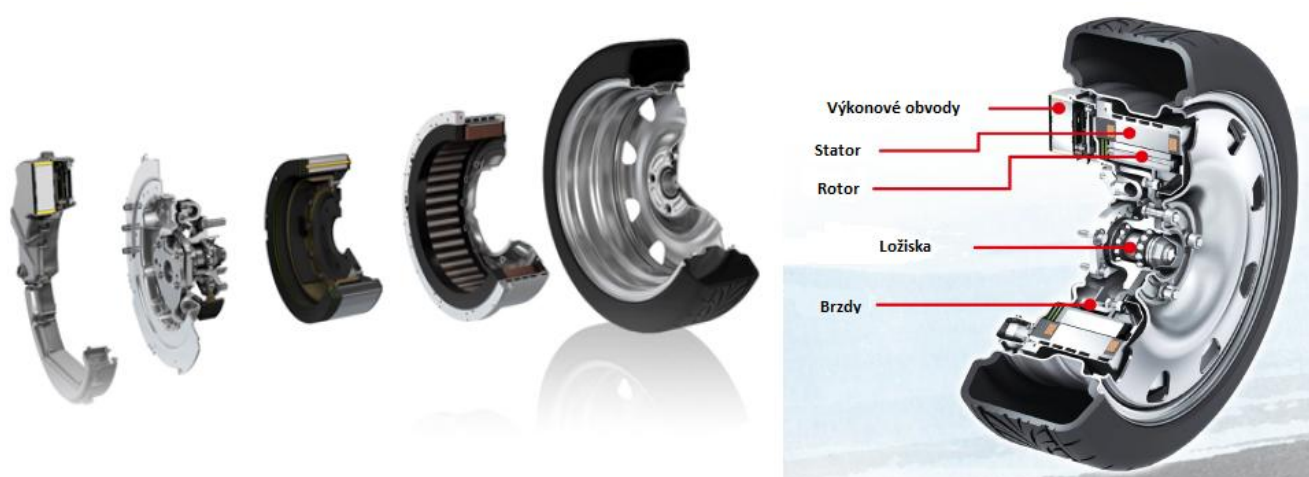
Obrázek 2-2: Konstrukční řešení systému E-Wheel Drive [16]
