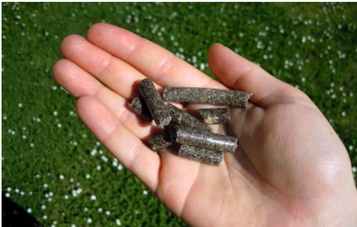
Obrázek 18 Agropelety vyrobené z energetického šťovíku (Zdroj: vlastní)
