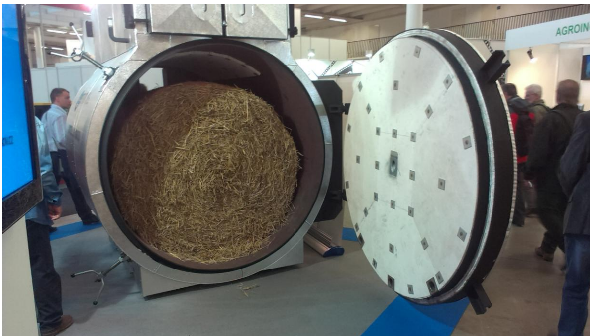
Obrázek 7 Zařízení na spalování celých balíků biomasy (Zdroj: vlastní)
