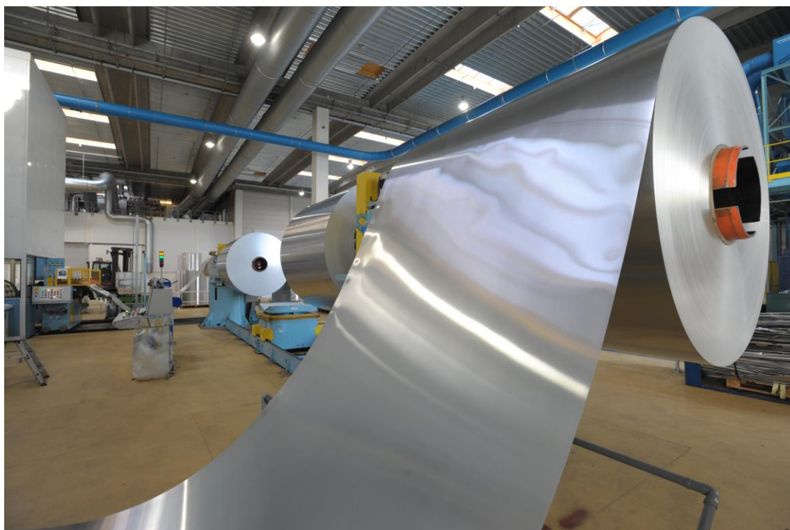
Obr. 7 Ukázka hliníkové folie pro výrobu hliníkových nápojových obalů [11]
