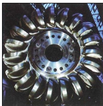
Obrázek č. 14: Oběžné kolo Peltonovy turbíny, převzato z [10]
