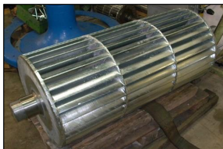
Obrázek č. 15: Oběžné kolo Bankiho turbíny, převzato z [43]
