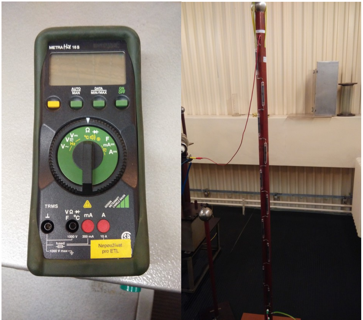
Obr. 0.8 Použitý voltmetr (vlevo) a použitý odporový dělič (vlevo)
