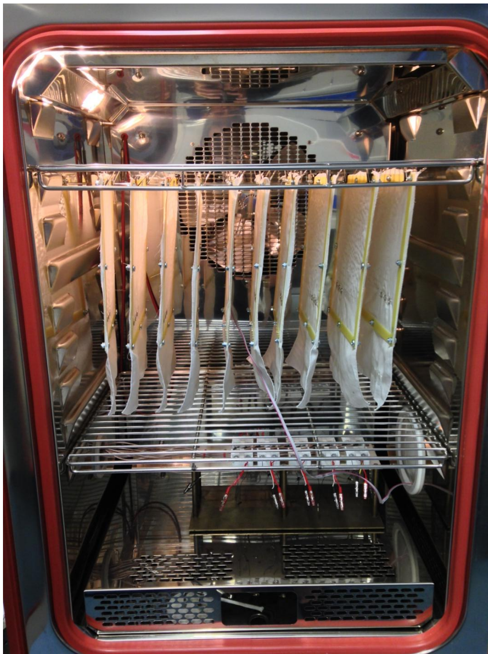
Obr. B.4: Umístění série vzorků v klimatické komoře Votsch VC 7018
