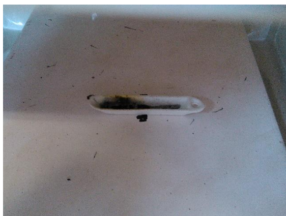
Obr. 20 Směs betulinu a měděného prášku po zahřívání v mikrovlnné troubě
