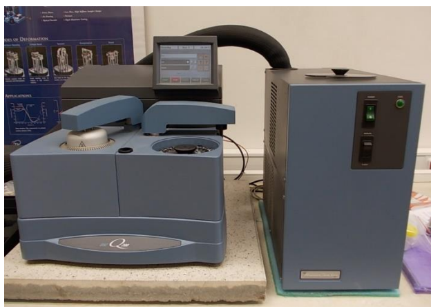
Obr. 3 Diferenciální skenovací kalorimetr, DSC Q200 od firmy TA Instruments
