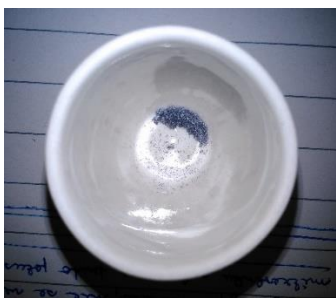
Obr. 31 Směs betulinu a \text{KHSO}_4 po zahřívání v mikrovlnné troubě
