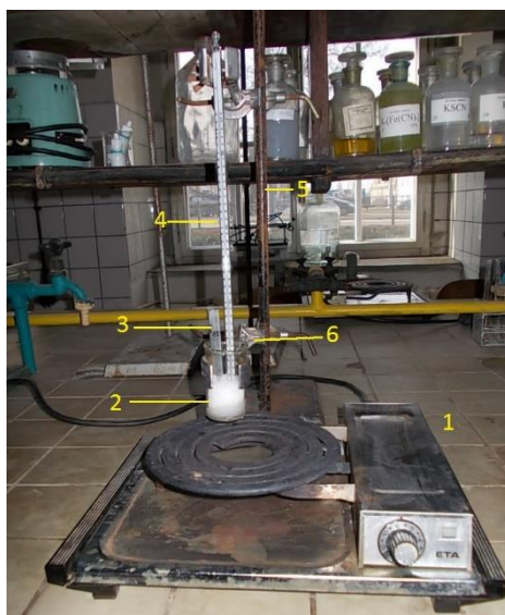
Obr. 47 Aparatura pro zahřívání v tavenině KHSO 4 , 1 elektrický vařič; 2 kádinka s KHSO 4 ; 3 zkumavka se směsí betulinu a KHSO 4 ; 4 teploměr; 5 stojan; 6 držák na chladič
