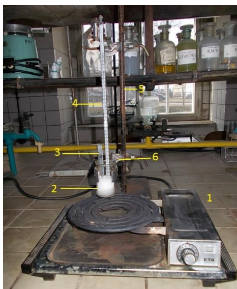
Obr. 68 Aparatura zahřívání betulinu s \text{KHSO}_4 v tavenině \text{KHSO}_4 , 1 elektrický vaříč; 2 kádinka s \text{KHSO}_4 ; 3 zkumavka se směsí betulinu a \text{KHSO}_4 ; 4 teploměr; 5 stojan; 6 držák na chladič
