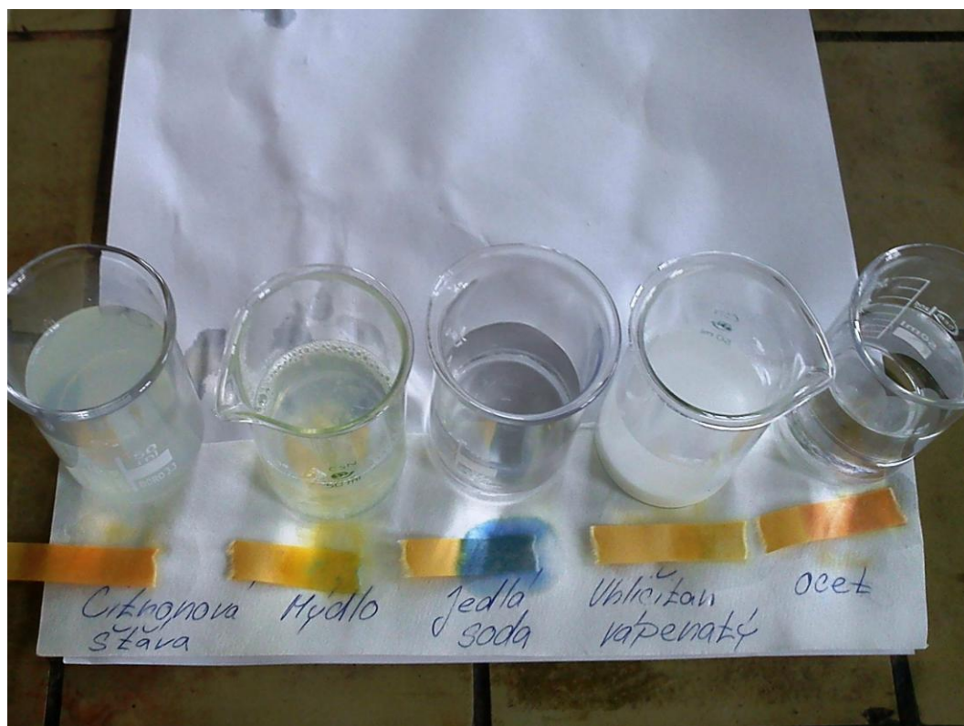
Obr. 7 Sledování pH různých roztoků - zbarvení univerzálního indikátorového papírku po namočení ve zkoumaných látkách (zdroj: vlastní foto)
