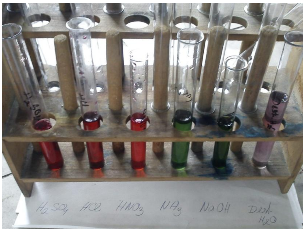
Obr. 32 Příprava indikátoru z červeného zelí - zbarvení indikátoru v roztocích \text{H}_2\text{SO}_4 , \text{HCl} , \text{HNO}_3 , \text{NH}_3 , \text{NaOH} a v destilované vodě (zdroj: vlastní foto)
