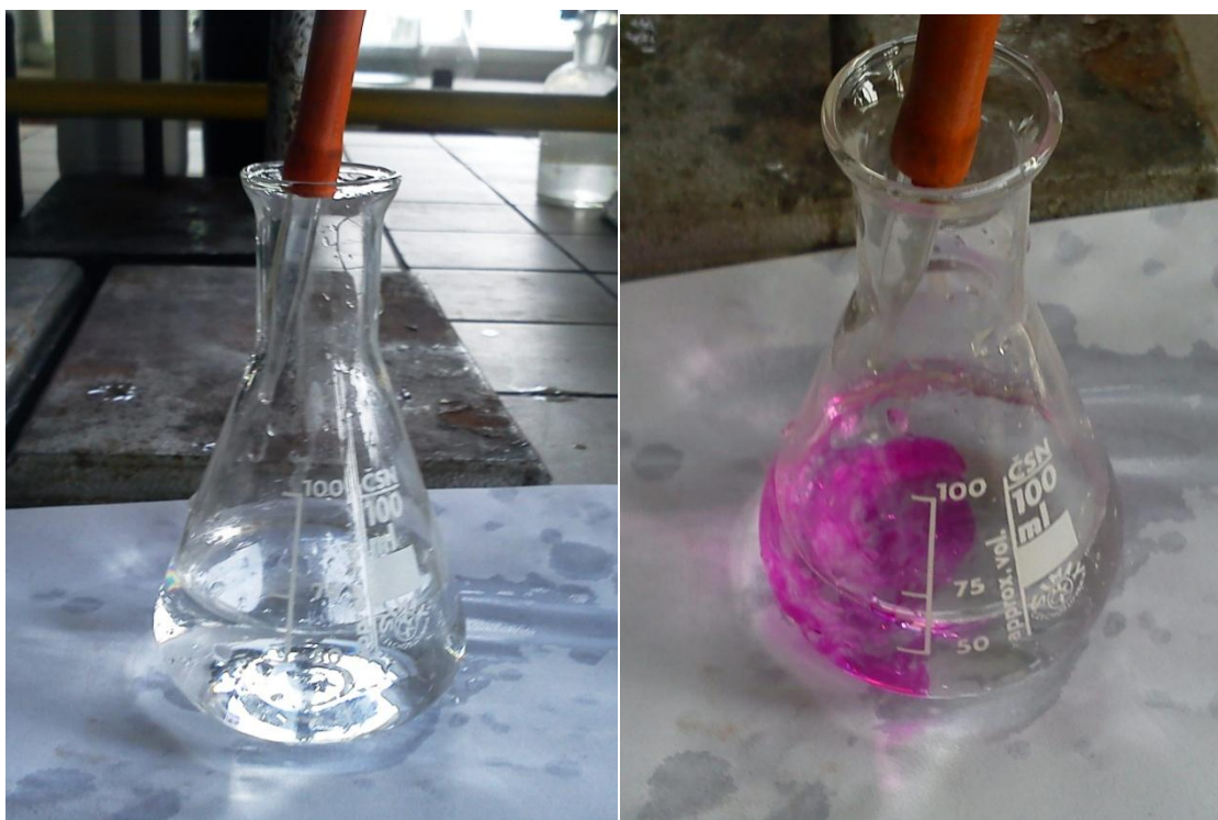
Obr. 35 Stanovení kyseliny octové v octu - titrace octa hydroxidem sodným na fenolftalein (zdroj: vlastní foto)
