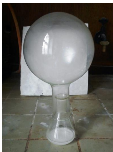
Obr. 17 Amoniaková fontána - aparatura na přípravu plynného amoniaku (zdroj: vlastní foto)
