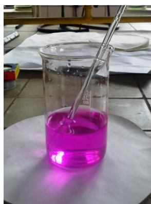
Obr. 23 Vydechování oxidu uhličitého – alkalický roztok fenolftaleinu (zdroj: vlastní foto)
