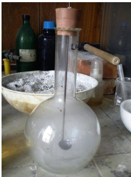
Obr. 20 Kyselé účinky oxidu siřičitého - jímání SO 2 do baňky (zdroj: vlastní foto)
