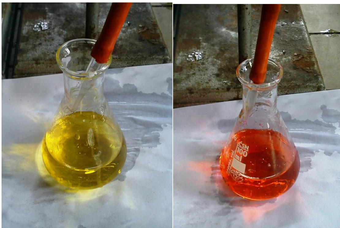
Obr. 36 Stanovení kyseliny octové v octu - titrace octa hydroxidem sodným na methyloranž (zdroj: vlastní foto)
