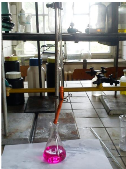
Obr. 34 Stanovení kyseliny octové v octu - titrační aparatura (zdroj: vlastní foto)
