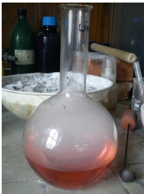
Obr. 22 Kyselé účinky oxidu siřičitého - voda s indikátorem methylořanží po protřepání s oxidem siřičitým (zdroj: vlastní foto)
