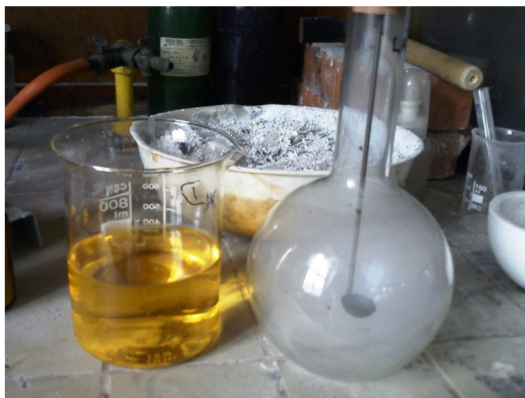
Obr. 21 Kyselé účinky oxidu siřičitého - voda s indikátorem methylořanží a baňka naplněná oxidem siřičitým (zdroj: vlastní foto)
