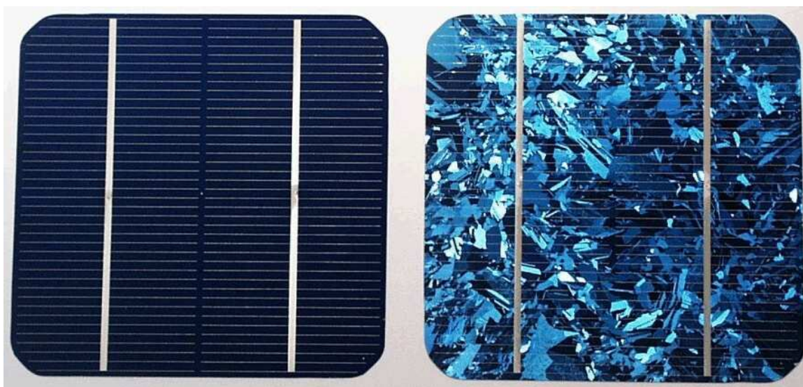
Obr. 2 – Zástupci první generace článků, zleva: monokrystalický, polykrystalický
