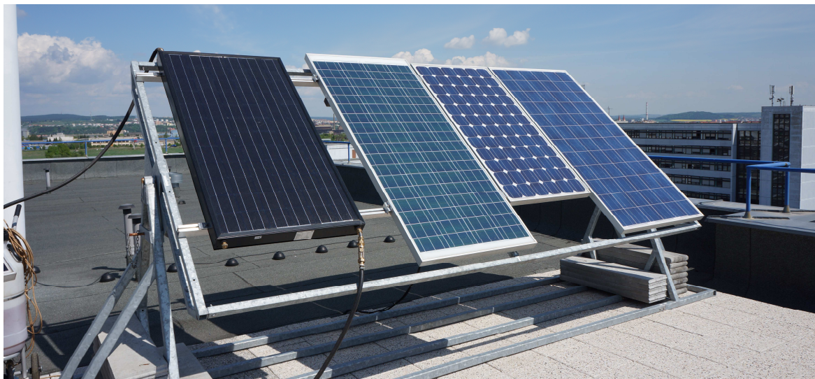
Obr. 18 - Systém se třemi panely. Zleva: kombinovaný FV-tepelný panel (není součástí systému), MY 145-CIGS, MY 180-M a MY 280-P.
