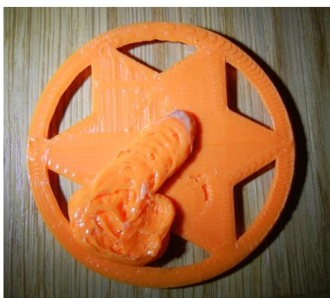
Obr. 59 – chyba 3D tiskárny
