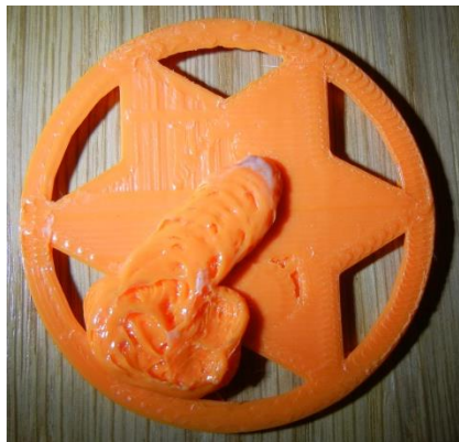
Obr. 59 - chyba vzniklá při tisku
