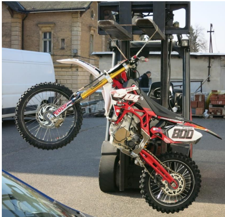
Obrázek 26 Měření momentu setrvačnosti
