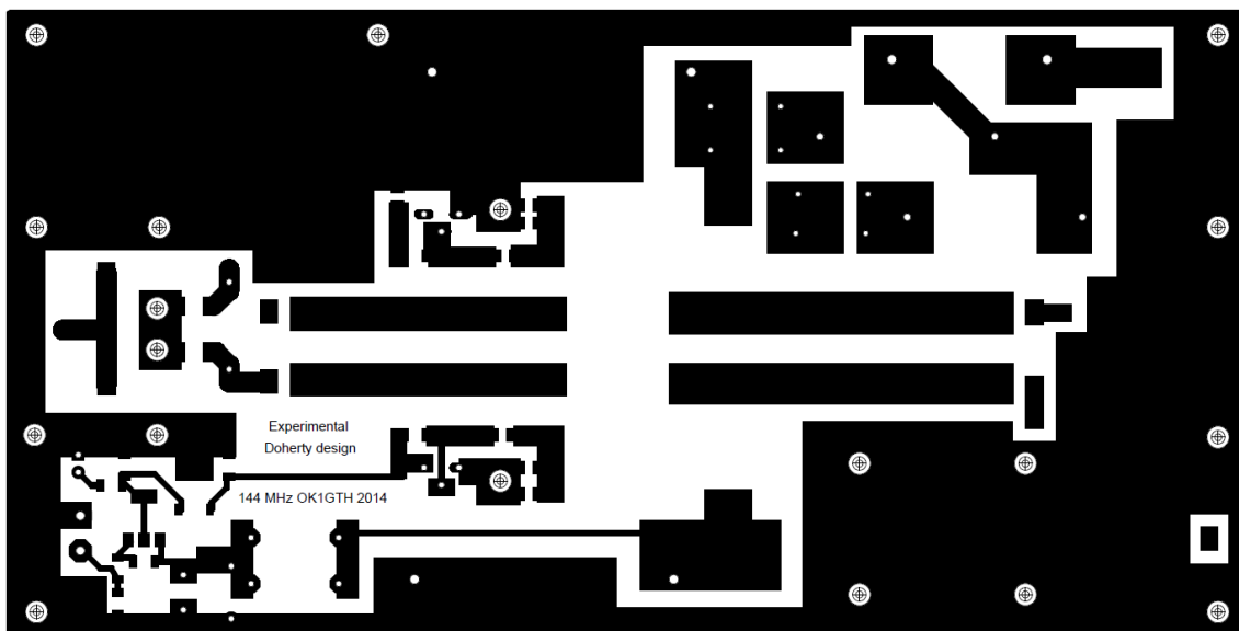
Obr. 2.47: Deska plošných spojů experimentálního Doherty zesilovače s BLF368.
