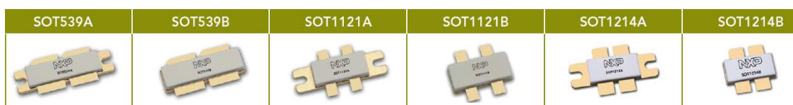
Obr. 2.4: Ukázka provedení pouzder výkonových LDMOS 50 V tranzistorů pro výkony 1400 – 200 W [21].
