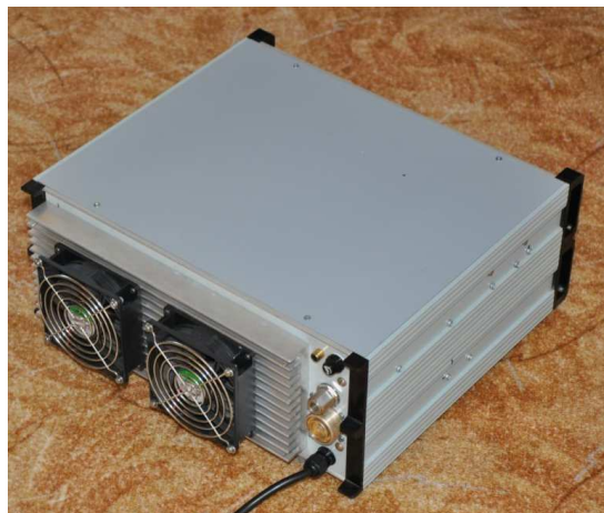
Příloha č. 7: Ukázka finálního provedení výkonového LDMOS zesilovače pro 144 MHz, chladící lavice pro testování LDMOS zesilovačů a dvojtónového NF generátoru
