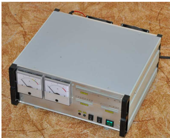
Příloha č. 7: Ukázka finálního provedení výkonového LDMOS zesilovače pro 144 MHz, chladící lavice pro testování LDMOS zesilovačů a dvojtónového NF generátoru
