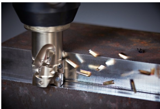
Obr. 2.1: Fréza Seco pro frézování do rohu Turbo 10 1 .
