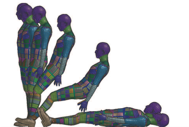
Obr. 104 Rozfázovaný pohyb cestujícího v časech 0, 200, 400, 600, 800, 1000, 1030 ms
