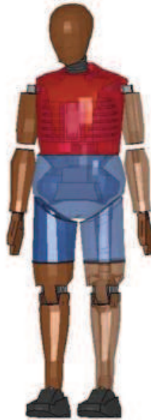
Obr. 39 „Rigid-FE“ model figuríny Hybrid III, zdroj: [LSTC]
