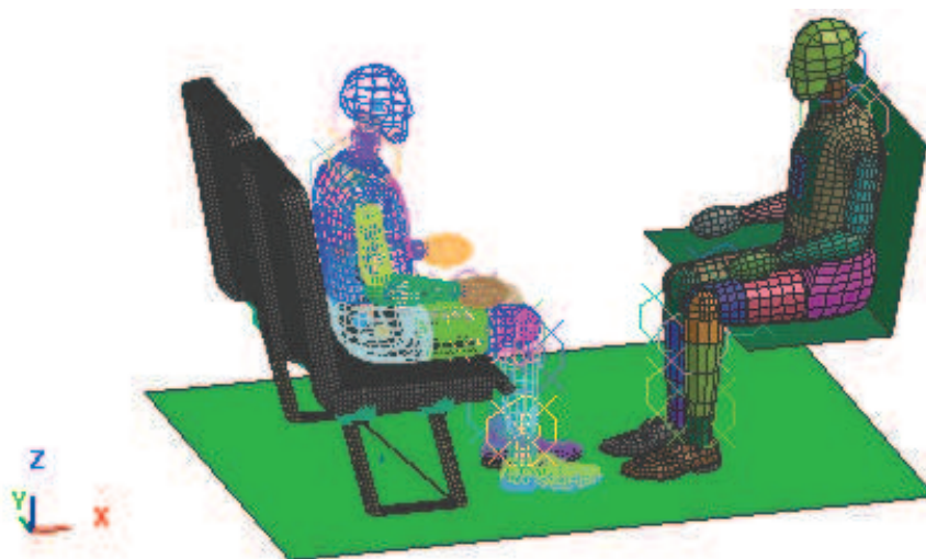
Obr. 33 Varianta kolize při čelním sezení s dvěma cestujícími
