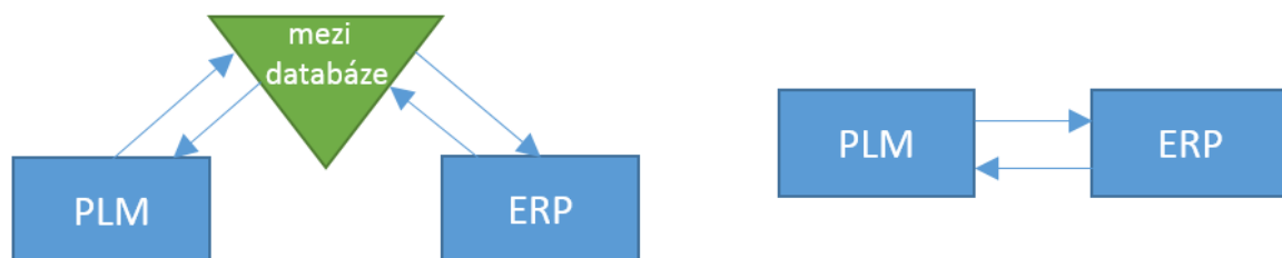
Obr. 7-31 schéma přenosu dat pomocí mezi databáze (vlevo) a přímou integrací (vpravo) [vlastní práce]
