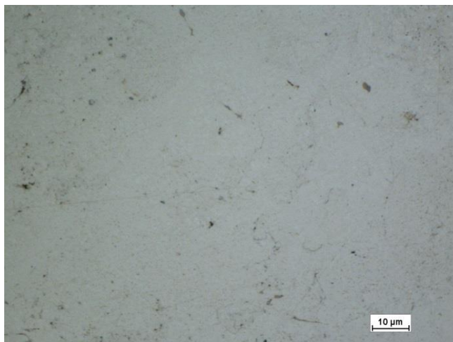
Obr. 155 Povrch a řez povlaku NiCrBSi po expozici v 1% HF + 0,2% Armohib
