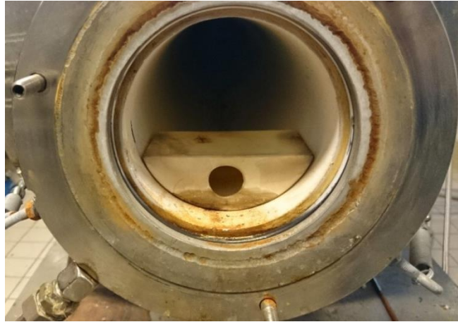
Obr. 39 Zařízení pro hodnocení odolnosti materiálů proti vysokoteplotní korozi
