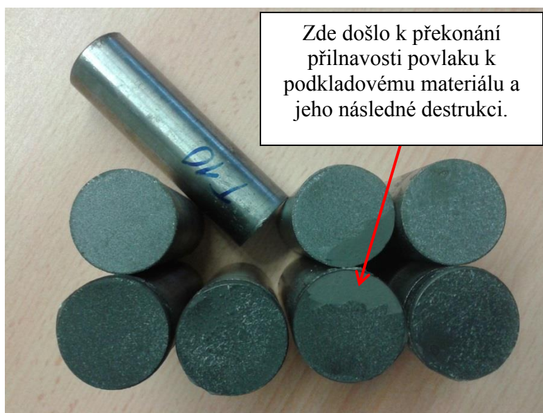
Obr. 50 Fotografie lomu u povlaku TiMoCN-Ni
