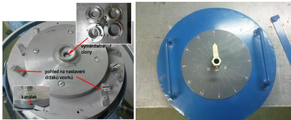
Obr. 29 Zařízení pro hodnocení erozivní odolnosti materiálů pracující na principu odstředivého unášení erodentu [66]
