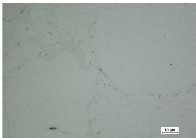
Obr. 149 Povrch povlaku Stellite 6 po expozici v 1% EDTA
