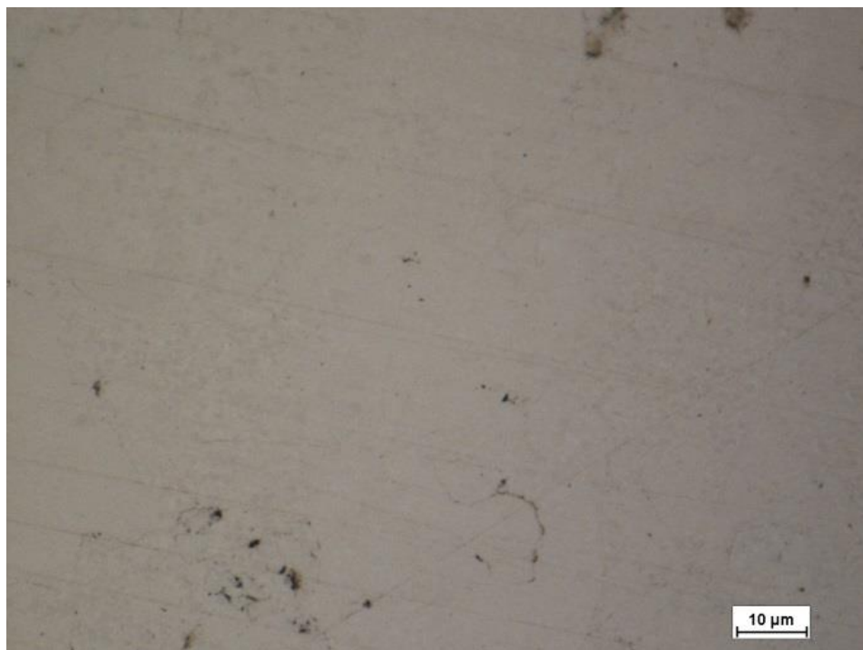
Obr. 153 Povrch povlaku NiCrBSi před expozicí
