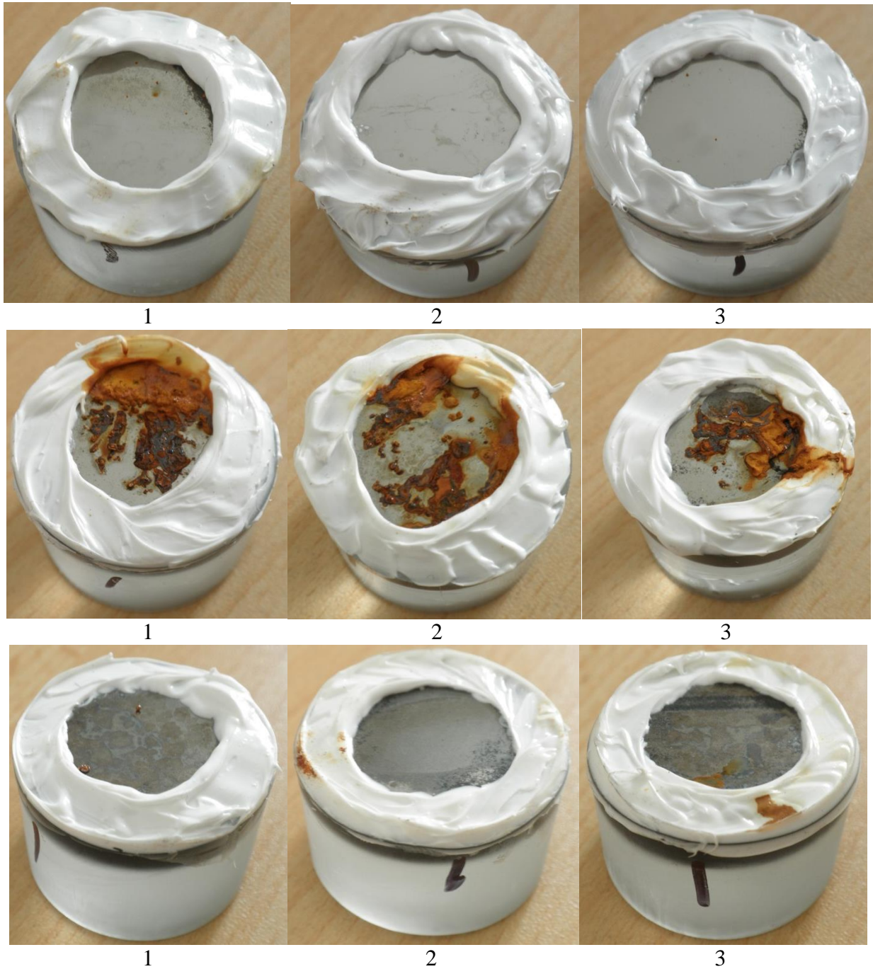
Obr. 212 Hodnocené cermetové povlaky sestupně \text{Cr}_3\text{C}_2 -25%NiCr, \text{Cr}_3\text{C}_2 -25%CoNiCrAlY a TiMoCN-Ni
