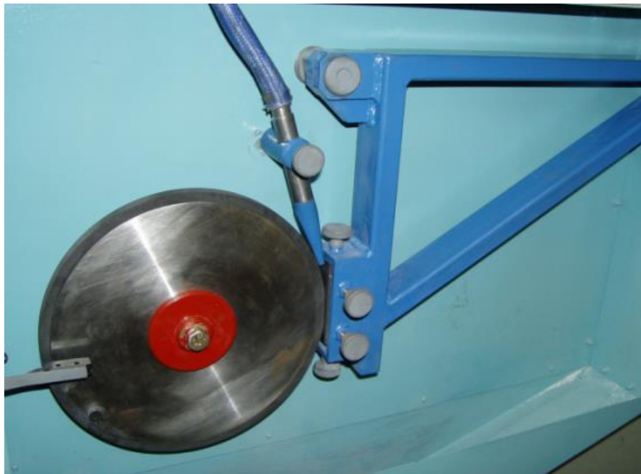
Obr. 25 Schéma a fotografie zařízení pro měření abrazivní odolnosti dle ASTM G-65 Dry Sand/Rubber Wheel test.
