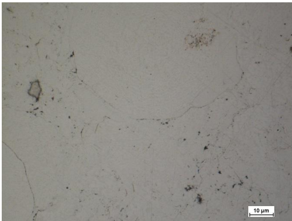
Obr. 148 Povrch povlaku Stellite 6 před expozicí
