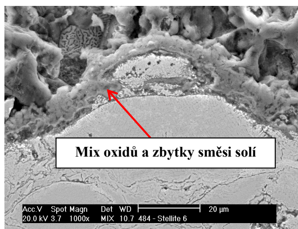
Obr. 86 Povlak Stellite 6 po expozici za teploty 575 °C
