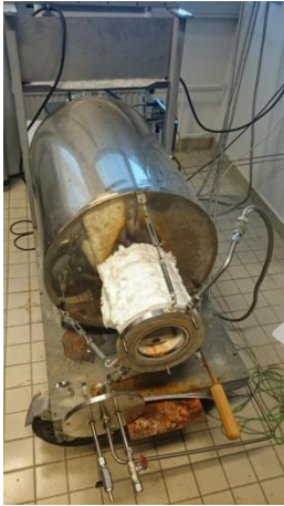
Obr. 39 Zařízení pro hodnocení odolnosti materiálů proti vysokoteplotní korozi
