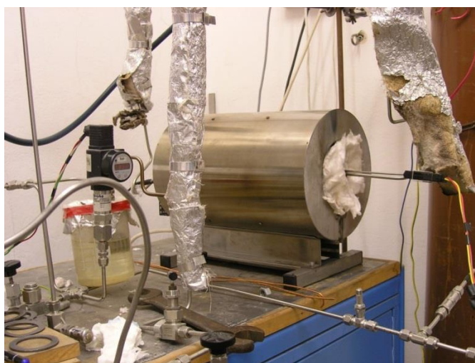
Obr. 32 Zařízení pro expozici v horké tlakové páře (SCW)
