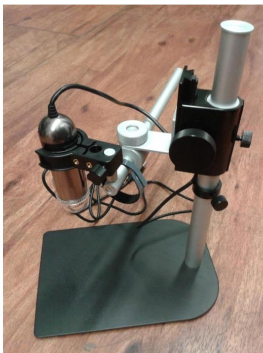
Obr. 41 USB mikroskop AM 7000 od firmy Dino-Lite Pro HR umístěný na stojanu
