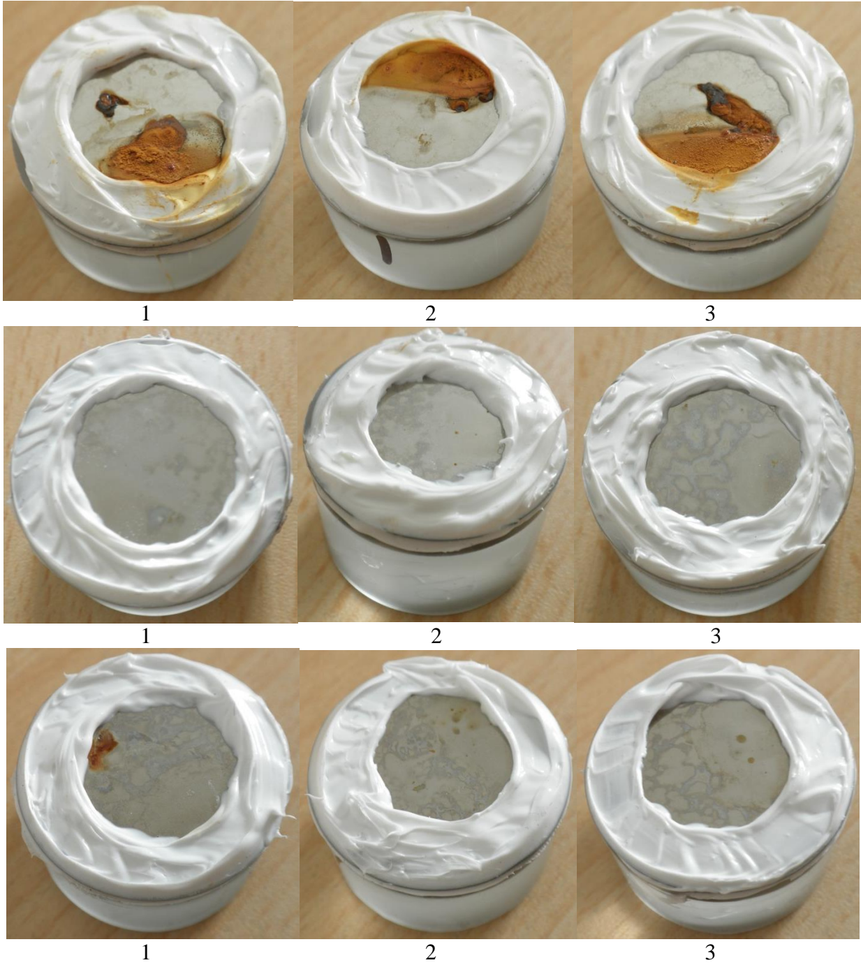
Obr. 213 Hodnocené slitinové povlaky sestupně Stellite 6, Hastelloy C-276 a NiCrBSi
