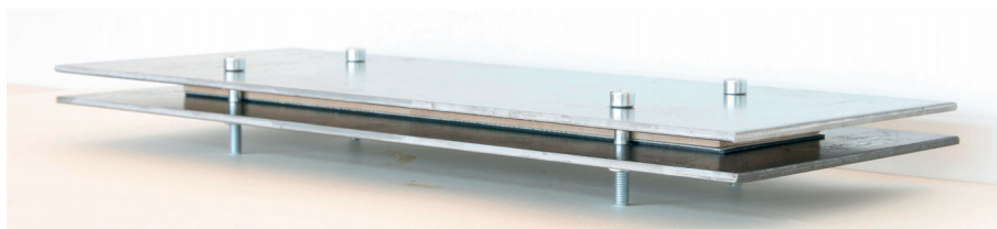
Obrázek 1: Zjednodušená část lyže ve svěracím zařízení před vytvrzením.
