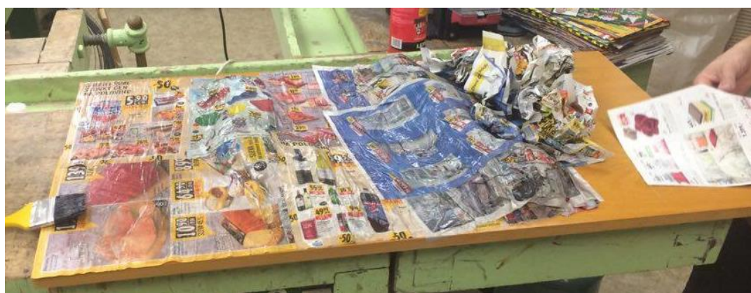
Obrázek 34: Výroba povrchu z novinového papíru a lepidla na tapety
