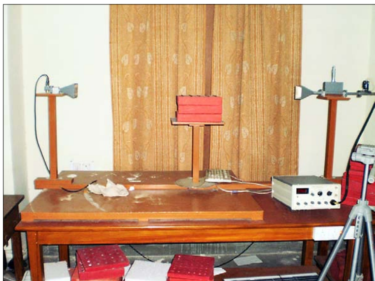
Obr. 13 – model difrakce na krystalech pomocí mikrovlnné soupravy
