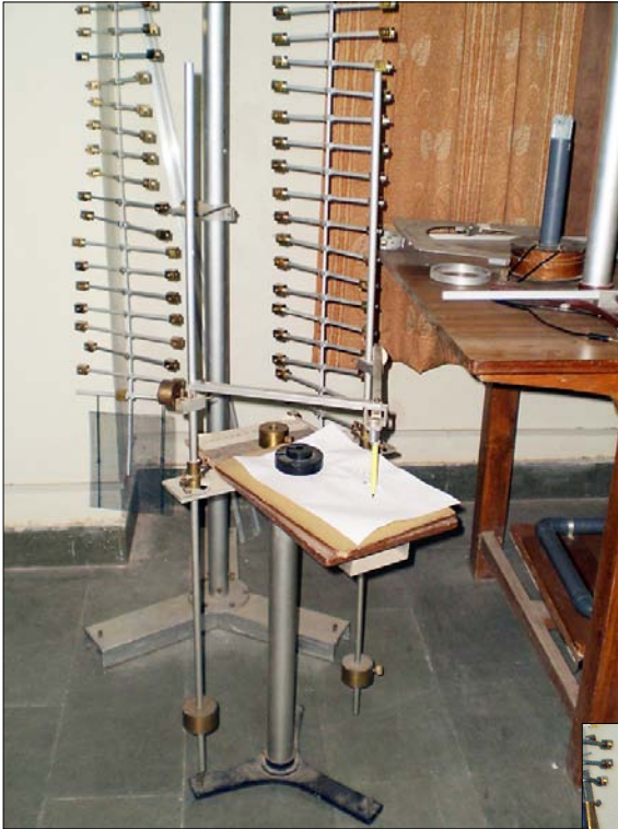
Obr. 9 – demonstrace skládání kolmých kmitů, „Lissajous apparatus“
