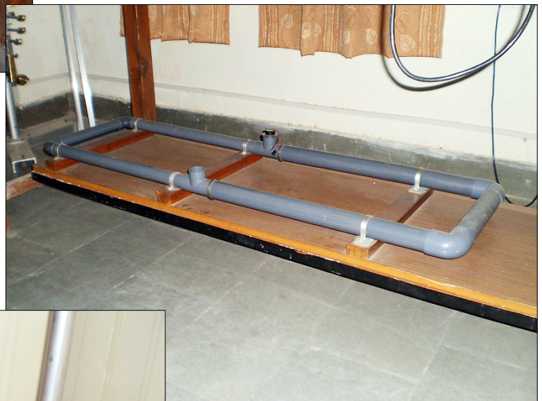
Obr. 11 – Quinckeho trubice z PVC
