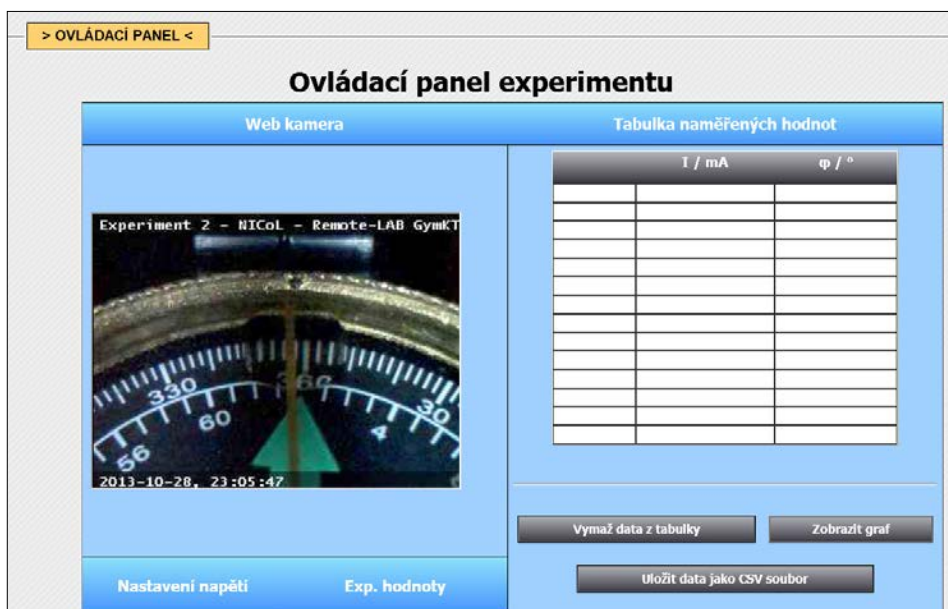
Obr. 4 – vzdálený experiment „Určení horizontální složky magnetického pole Země“ [zdroj: http://remote-lab.fyzika.net/experiment/02/experiment-2.php?lng=cz ]
