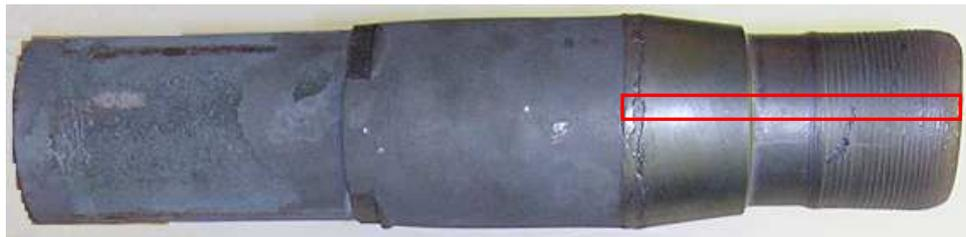
Abb. 2: Experimenteller Teil gefertigt durch das Bohrungsdrücken bei inittierungstemperatur von 900°C, Teil mit Bohrung rechts, Halbzeug Mitte, Probenträger links
