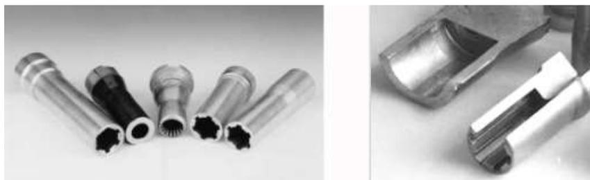
Abb. 1: Beispiele von Hohlteilen, hergestellt durch das Bohrungsdrücken
