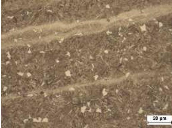
Abb. 8: Stationärer Bereich 3, CMnSiCr, Martensitmatrix mit dispergiertem Ferrit, LM
