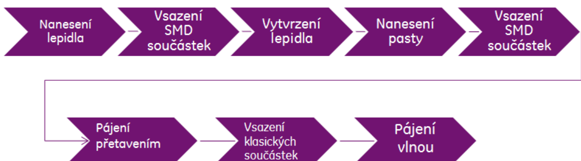
Obrázek 48: Jednotlivé kroky procesu pájení.
