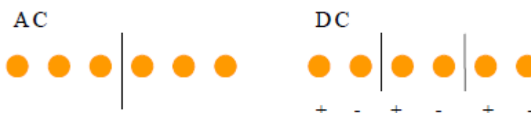
Obr. 5.8. Převodění zapojení klasické dvojpotařové linky na DC provoz [1].
